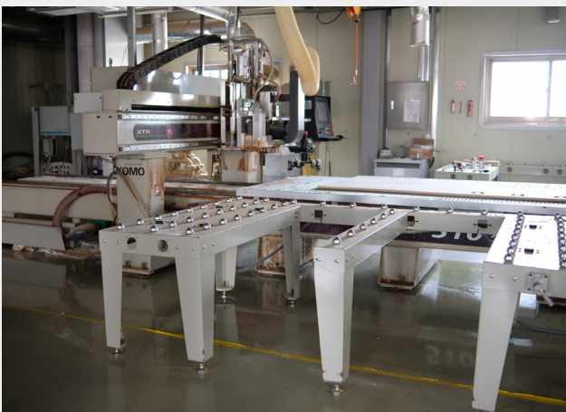
해당 CNC 생산설비를 통해 클레어 브라더스의 스피커 인클로저가 생산된다.
