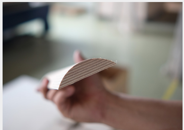
XYZ축이 동시에 움직이는 3D CNC 생산설비를 통해 단면이 아닌 곡면을 생산할 수 있다.
